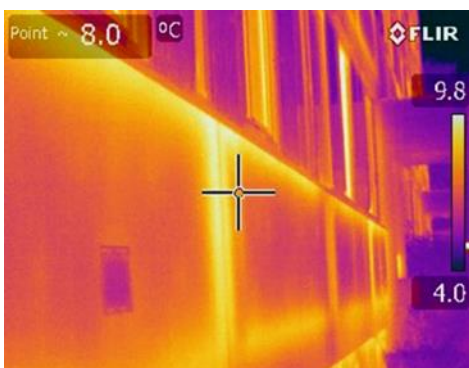
Images infrarouge prises lors de l'audit A l'intérieur, les zones sombres sont des zones froides sur lesquelles va se former la condensation. Depuis l'extérieur, les zones les plus claires sont celles par lesquelles les pertes de chaleurs sont les plus importantes
