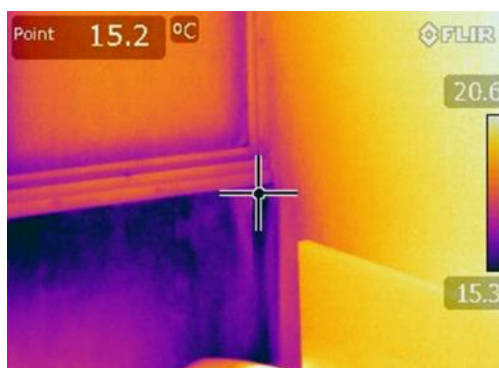
Images infrarouge prises lors de l'audit A l'intérieur, les zones sombres sont des zones froides sur lesquelles va se former la condensation. Depuis l'extérieur, les zones les plus claires sont celles par lesquelles les pertes de chaleurs sont les plus importantes
